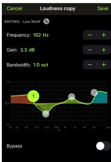
Utilizzate la modalità verticale per selezionare e regolare facilmente la frequenza, il guadagno e la larghezza di banda.
