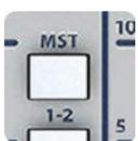
Il Fader regola il livello tra -infinito (nessun segnale) e +10dB. La linea 0dB indica l'unità (nessuna modifica di livello).
