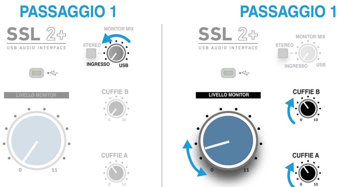
**ATTENZIONE!** Se stai usando un microfono e monitorando l'**INPUT (INGRESSO)**, fai attenzione nel girare la manopola **MONITOR LEVEL (LIVELLO MONITOR)** verso l'alto perché potrebbe determinare un ciclo di feedback se il microfono è vicino alle casse. Tieni il controllo del monitor a livello basso o effettua il monitoraggio attraverso le cuffie.
