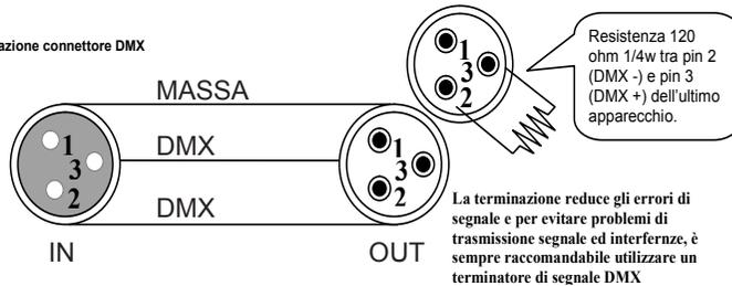
**Attenzione:** Verificate l'integrità del cavo e la corretta polarità dei connettori prima di effettuare i collegamenti.
