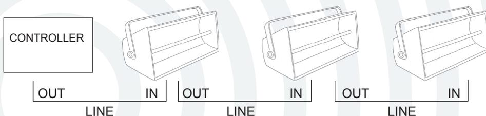
**Tramite centralina DMX:** collegare il cavo di segnale come indicato nel disegno seguente utilizzando i connettori DMX IN/OUT (11-12) attraverso i quali potranno essere collegati a cascata altri apparecchi DMX. Posizionare il dipswitch 10 su “OFF” e 1 su “ON”.
