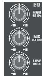
Fig. 2.2: regolazione del suono dei canali d'ingresso mono
