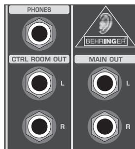
Fig. 2.9: Connettori Monitor Mix e Main Mix
