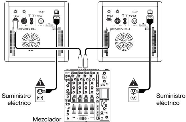
Conecte la salida izquierda y derecha de su mezclador a la **entrada 1** de cada altavoz mediante cables XLR o TRS de 6,35 mm (1/4 pulg.). Asegúrese de que los **selectores Line/Mic** (Línea/Mic) estén en **Line**.
