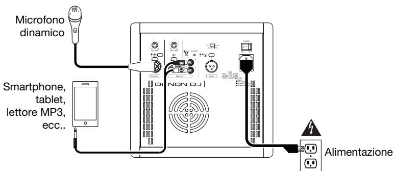
Collegare un microfono dinamico all'**Ingresso 1** servendosi di un cavo XLR o TRS da 6,35 mm (1/4"). Assicurarsi che il **Selettore Line/Mic** sia impostato su **Mic**. Collegare un media player (smartphone, tablet, lettore MP3, ecc.) ai connettori RCA dell'**Ingresso 2** servendosi di un cavo da 3,5 mm a RCA (da 1/8" a RCA).
