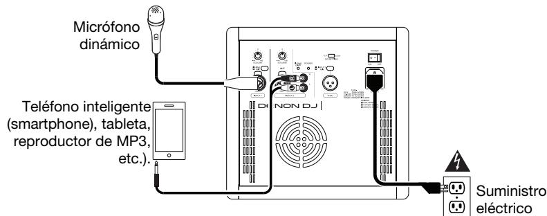
Conecte un micrófono dinámico a la **entrada 1** mediante un cable XLR o TRS de 6,35 mm (1/4 pulg.). Asegúrese de que el **selector Line/Mic** (Línea/Mic) esté en **Mic**. Conecte un reproductor de medios (teléfono inteligente [smartphone], tableta, reproductor MP3, etc.) a los conectores RCA de la **entrada 2** mediante un cable de 3,5 mm a RCA (1/8 pulg. a RCA).
