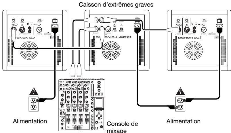
Branchez les sorties gauche et droite de la console de mixage à l'entrée du caisson d'extrêmes graves, puis branchez les sorties passe-haut du caisson d'extrêmes graves à l'entrée de chaque enceinte en utilisant des câbles XLR ou TRS 6,35 mm. Veuillez vous assurer que les **sélecteurs Line/Mic** sont réglés sur **Line**.
