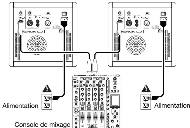
Branchez les sorties gauche et droite de la console de mixage à l'**entrée 1** de chaque enceinte en utilisant des câbles XLR ou TRS 6,35 mm. Veuillez vous assurer que le **sélecteur Line/Mic** est réglé sur **Line**.
