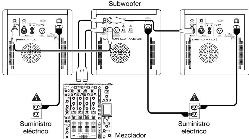
Conecte las salidas izquierda y derecha de su mezclador a las entradas de su subwoofer mediante cables XLR o TRS de 6,35 mm (1/4 pulg.), y a continuación, conecte cada **salida pasaaltos** del subwoofer a la **entrada 1** de cada altavoz. Asegúrese de que los **selectores Line/Mic** (Línea/Mic) estén en **Line**.
