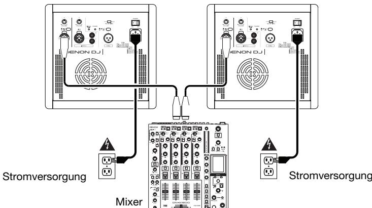
Verbinden Sie den linken und rechten Ausgang Ihres Mixers mit **Eingang 1** jedes Lautsprechers mit einem XLR- oder 6,35mm Klinkenkabel. Sorgen Sie dafür, dass die **Line/Mic-Wahlschalter** auf **Line** eingestellt sind.
