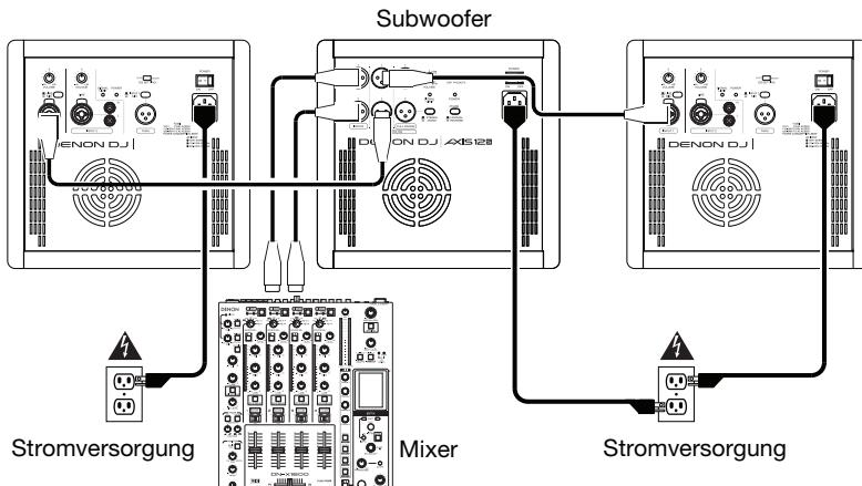
Verbinden Sie die linken und rechten Ausgänge des Mixers über XLR-Kabel oder 6,35mm TRS-Kabel mit dem Eingang Ihres Subwoofers und schließen dann den Hochpassausgang des Subwoofers an den **Eingang 1** jedes Lautsprechers an. Sorgen Sie dafür, dass die **Line/Mic-Wahlschalter** auf **Line** eingestellt sind.
