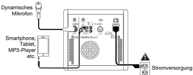
Schließen Sie ein dynamisches Mikrofon mit einem XLR- oder 6,35mm TRS-Kabel an **Eingang 1** an. Sorgen Sie dafür, dass der **Line/Mic-Wahlschalter** auf **Mic** eingestellt ist. Schließen Sie einen Media-Player (Smartphone, Tablet, MP3-Player etc.) mit einem 3,5mm-auf-Cinch-Kabel an die Cinch-Buchsen von **Eingang 2** an.
