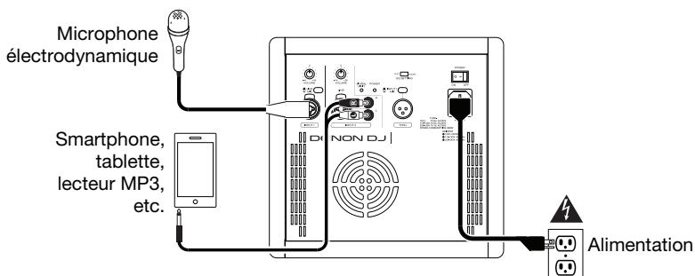
Branchez un microphone électrostatique à l'**entrée 1** à l'aide d'un câble XLR ou TRS 6,35 mm. Veuillez vous assurer que le **sélecteur Line/Mic** est réglé sur **Mic**. Branchez un lecteur multimédia (smartphone, tablette, lecteur MP3, etc.) aux connecteurs RCA de l'**entrée 2** à l'aide d'un câble 3,5 mm vers RCA.
