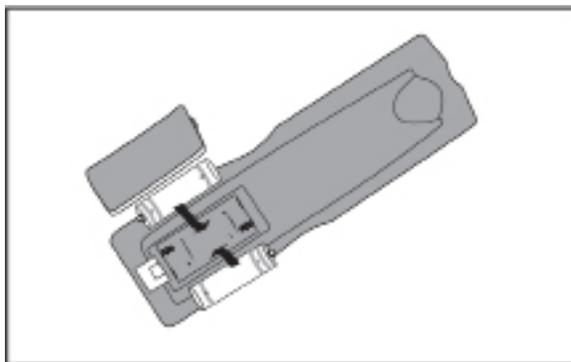
Per la sostituzione delle batterie, rimuovete il coperchietto posto sul retro del telecomando ed inserite 2 batterie rispettando le polarità indicate.
