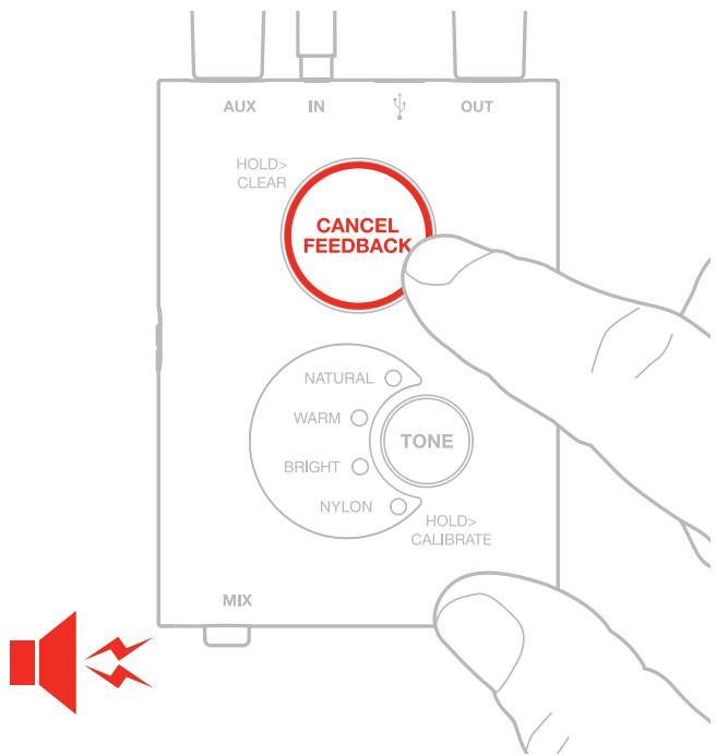
在出现反馈的情况下点击“CANCEL FEEDBACK”（取消反馈）按钮，恼人的频率会立即消失，从而消除反馈，而不会损坏音质。这种功能设置单个消除滤波器（多达10个）适用多种反馈频率。
