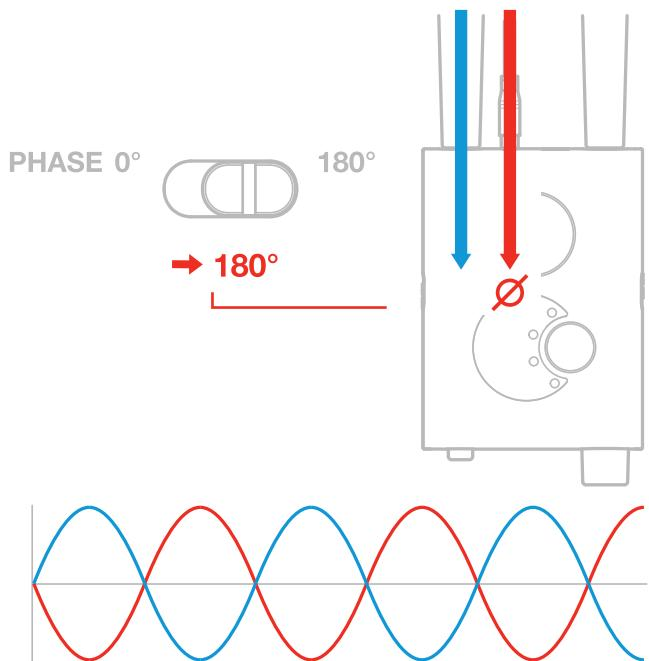
相位翻转开关( $0^\circ$  - $180^\circ$ )工作预混。当MEMS和Piezo都连接时，相位开关作用于MEMS信号。只有MEMS连接时作用于MEMS信号。只有Piezo连接时作用于Piezo信号。
