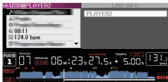
Si possono controllare i dettagli dei brani contenuti in un altro lettore DJ collegato via PRO DJ LINK.
